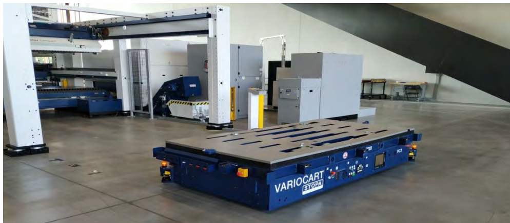
El AGV, transporta el material para alimentar las máquinas
