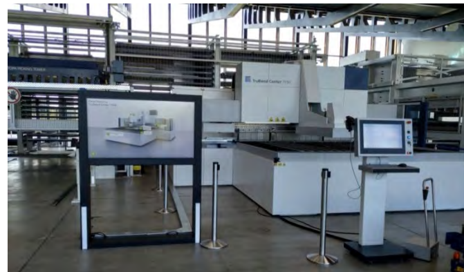
Paneles de monitorización y control a pie de cada máquina
